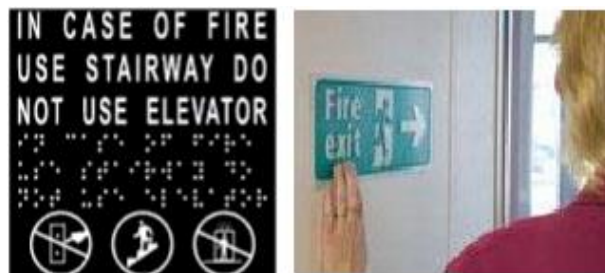
Εικόνα 14. Σήματα διαφυγής σε ανάγλυφη γραφή τυφλών (Braille) για να μπορούν να διαβαστούν από άτομα με προβλήματα όρασης (NFPA, Σχεδιασμός Εκκένωσης σε Έκτακτες Καταστάσεις-Οδηγός για Άτομα με Αναπηρία, Ιούνιος 2016) [4]
